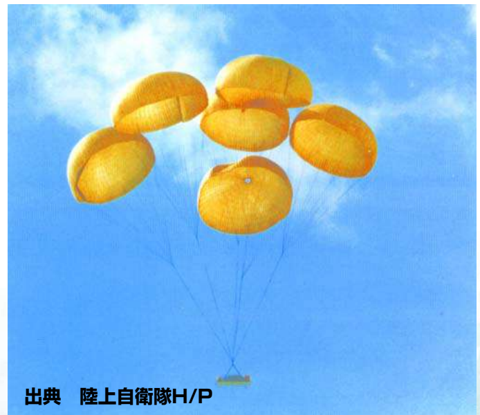
重量物投下器材、物料傘1号
